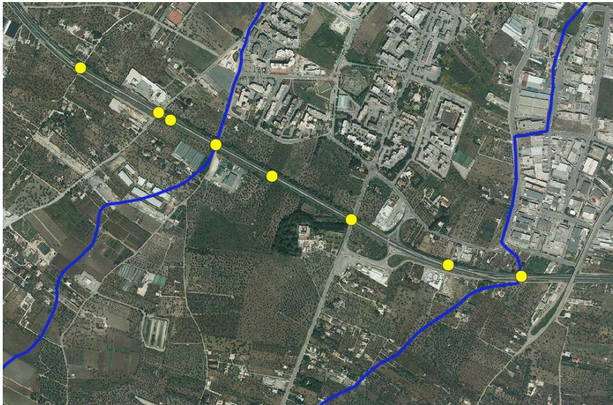
Rilievo topografico in sito condotto con strumentazione GPS di precisione. I punti neri e verdi rappresentano il dato rilevato, i particolare i tombini idraulici al di sotto della SS16
