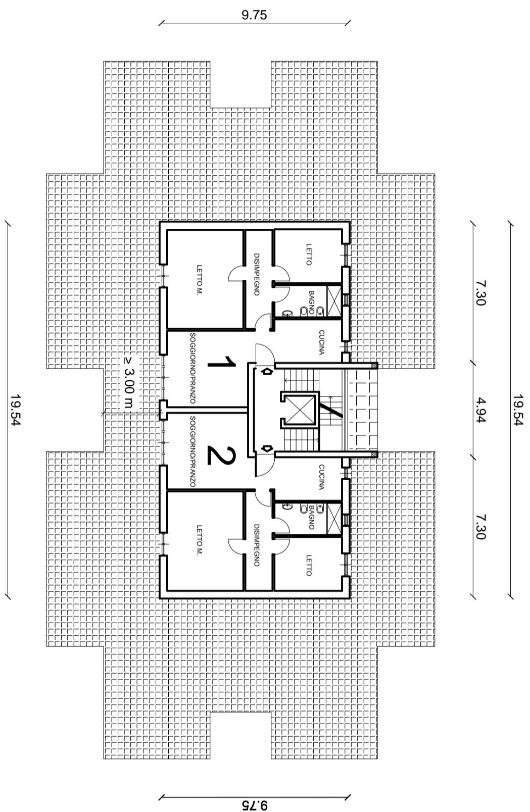
PIANO ATTICO : sup.netta 142.82 mq ; h = 2.70 m ; Vol. netto: 385.61 mc; Vol. edificio 4A = 4B = 4C = 4D : 6169.68 mc.
