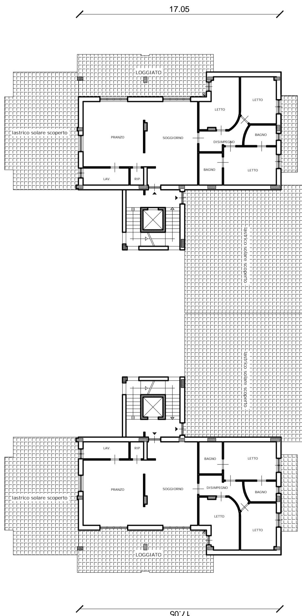
**PIANO ATTICO :** sup.netta 124.71 mq ; h = 2.70 m ; Vol. netto: 336.72 mc; Vol. edificio 6B = 6C: 4835.57 mc.
